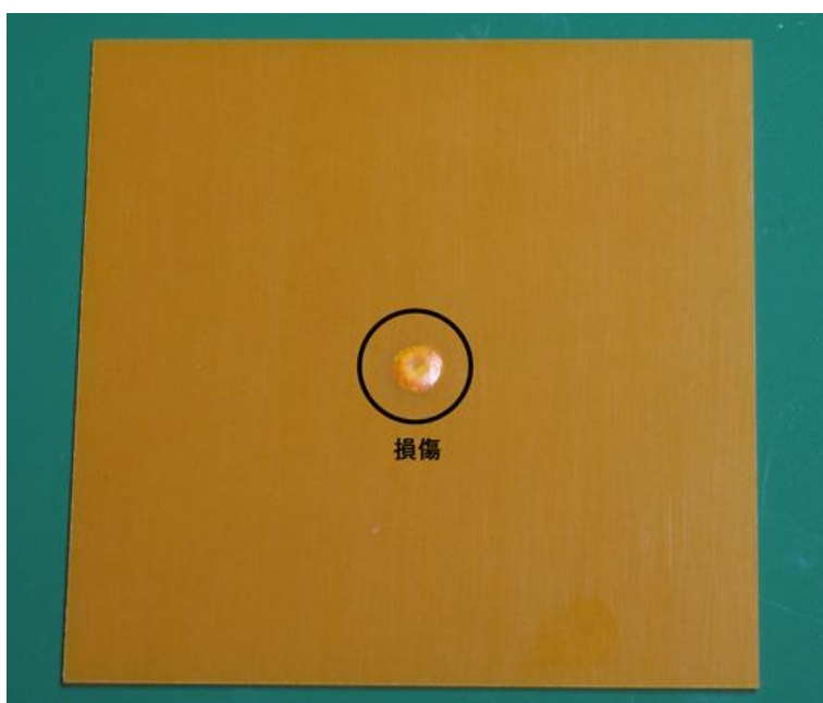
写真 3(c) たった 10 秒後にフェノール 積層板は変形してしまった
