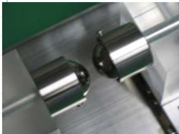
(1) ギャップ3.2mmの場合5kVrmsを印加しても放電しない
